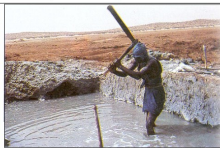
Dégagement des couches de sel à N'Terert, Trarza
