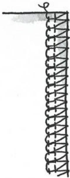
Figure 6-6 Une couture de 0,6 cm faite avec une surjeteuse.
