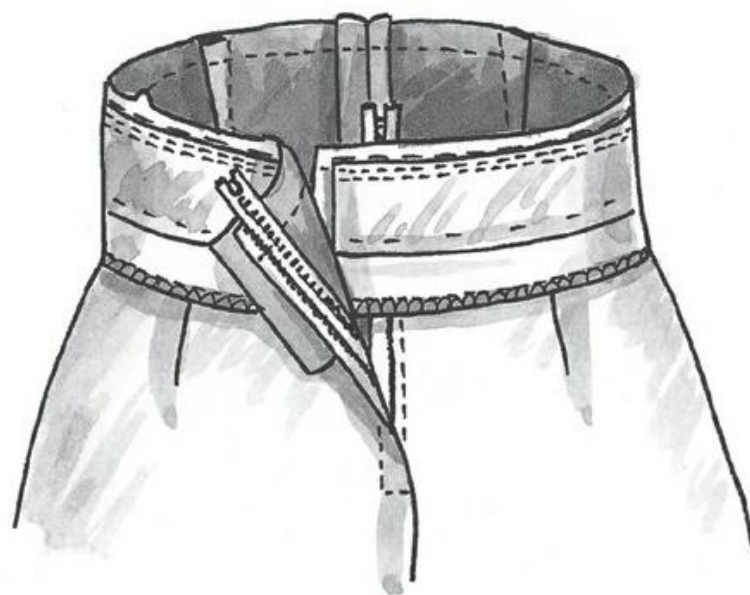
Figure 9-10 Cousez la ceinture, puis coupez le surplus de ruban de la fermeture à glissière.
