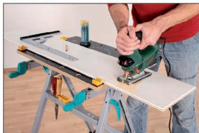
Serrage d'une pièce longue sur un établi étau
