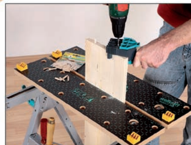
Travail en bout d'une pièce serrée avec l'établi
