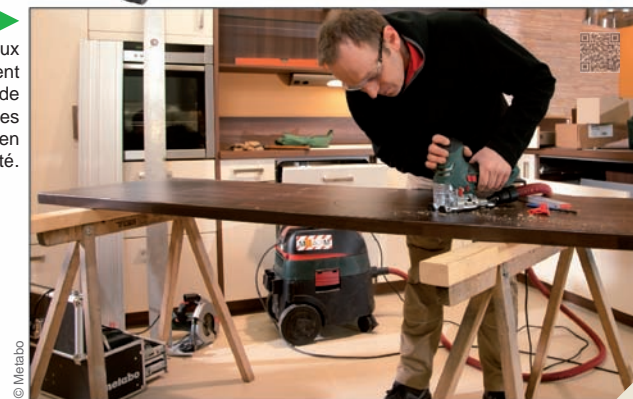
Travail en bout d'une pièce serrée avec l'établi
