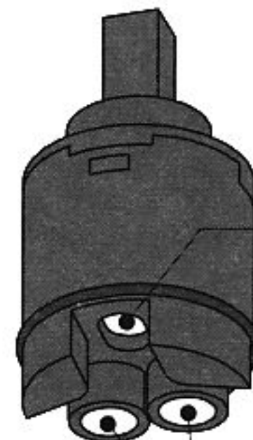
sortie eau mitigée
