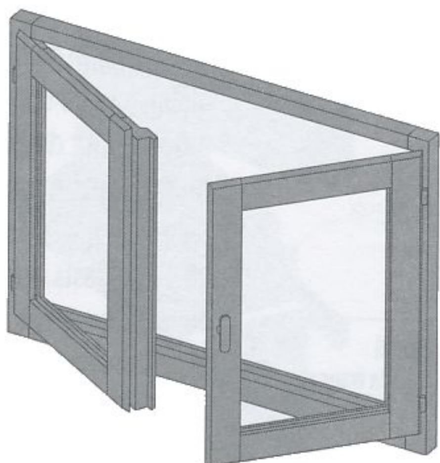
fig. 11.1 fenêtre isolante en bois à deux vantaux
