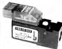
Mini-électrovanne à commande directe corps à applique 3/2. Embase Ø M3
