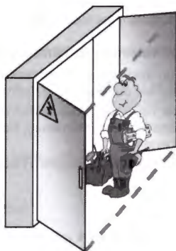
Exemple de local ouvert (en cours d'intervention, l'opérateur forme écran)
