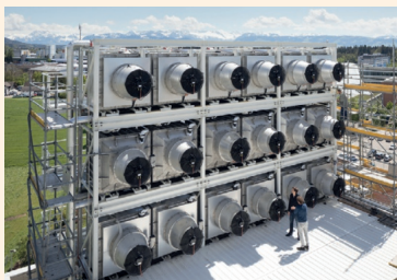
Séquestration du CO 2 de l'atmosphère par Climeworks, à Zurich, en Suisse
